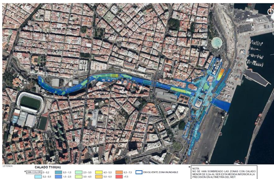
**Figura 31.** Ejemplo de mapa de peligrosidad (calados del agua) para el escenario de probabilidad media (100 años de periodo de retorno). Fuente: Mapa de Peligrosidad y Riesgo de Inundación de la Demarcación Hidrográfica de Tenerife. Elaboración propia.
